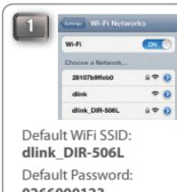
Gehen sie bei ihrem PC oder mobilen Gerät in die WLAN Einstellungen und verbinden sie sich mit dem WLAN des DIR-506L.
